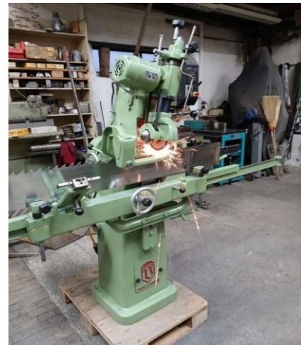
Schärfautomat VOLLMER Cne, Jg 1959
